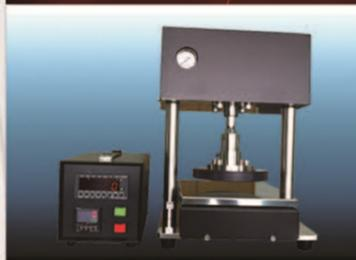
充填密封后的破袋检查装置，压力可设定为0.1kg。
