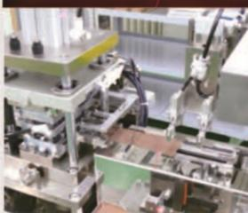
一种使用激光修剪热固性树脂包装的电子零件上的毛刺的设备。
