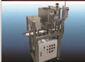
皮带式封盖机输出扳机和泵盖也可以通过该单元进行操作，并且可以轻松执行扭矩控制。
