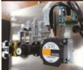
一种在各种条件下从光学电子元件的发光部分发出光，测量光接收元件的输出信号并确认质量的设备。
