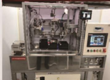
电池生产机，小批量，多品种的灌装封盖装置，可以由一个人装卸的装置。
