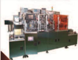
通过涂覆树脂涂层来组装CCD相机单元，例如数码相机，手机和智能手机。
