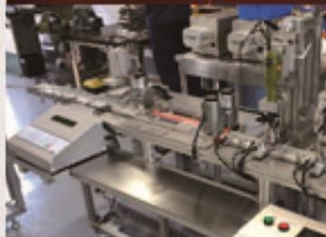
用于小型容器的在线灌装封盖机可以在包装箱中包装，在卸货时具有对齐功能。
