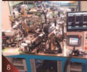
将钼丝插入汽车前灯灯丝的机器(自动供电，自动插入，自动填缝)\*将0.18钼丝插入0.2毫米线圈中
