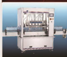
这是用于液体的高速灌装装置，也可以进行后续灌装。由于机器的前部和后部可以用传送带连接，因此可以用于各种工件。
