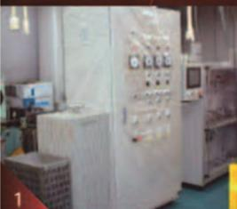
面板完成后可测量尺寸并耐压的设备。
