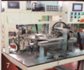
将Mo箔Pt箔焊接到汽车前灯灯丝上的机器(自动供电，自动填缝)\*将0.18钼丝插入0.2毫米线圈中
